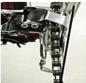
De seguida, devemos colocar a corrente no prato pedaleiro maior e na roda dentada mais pequena da cassette, ajustando o parafuso limitador H, de forma a que o espelho exterior da mudança fique próximo da corrente (conforme foto).
