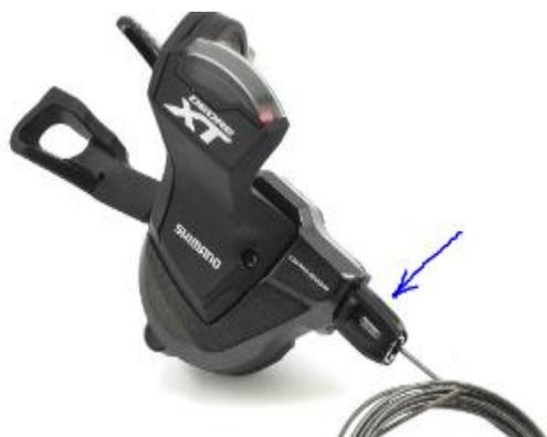
**Nota:** a regulação da tensão do cabo é feita diretamente no parafuso de engate do cabo no manípulo das mudanças e é até mais importante e crítica do que a regulação dos parafusos limitadores, pois se as mudanças não estão passando bem, tanto para cima, quanto para baixo, provavelmente um ajuste *fino* da tensão do cabo basta para tornar as trocas mais suaves, sem raspar e patinar.
