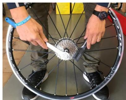
De seguida, devemos preparar a cassette nova, começando a sua montagem colocando-a no núcleo, tendo em atenção que tanto os pinhões como o núcleo têm umas ranhuras que devem coincidir para que a cassette encaixe.
