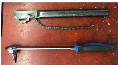
Vamos então abordar o tema, tendo como ponto de partida a necessidade de ter as ferramentas adequadas (chave para cassetes, chave de corrente, lubrificante), a cassette e a corrente novas, tendo em atenção a compatibilidade com a *bike*.
